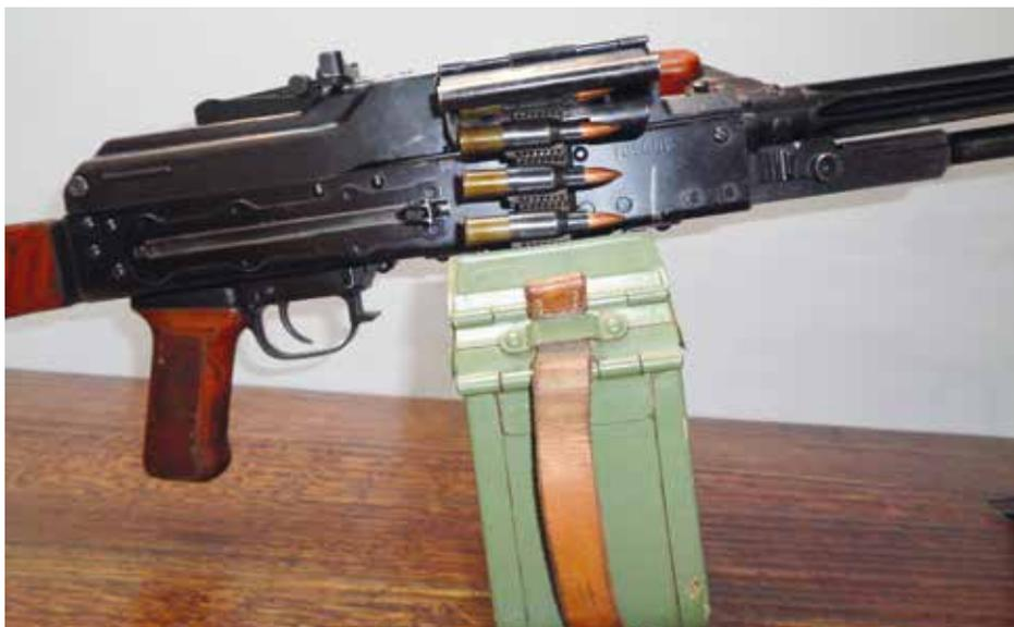
arma totalmente ridisegnata in calibro 7,62x54 R alimentata con nastri non disintegrabili da 100, 200 e 250 colpi. Una delle particolarità consiste nel fatto che la presa di gas necessaria all'arretramento dell'otturatore è posizionata sotto la canna, al contrario agli altri metodi utilizzati ad esempio nell'AK47.
