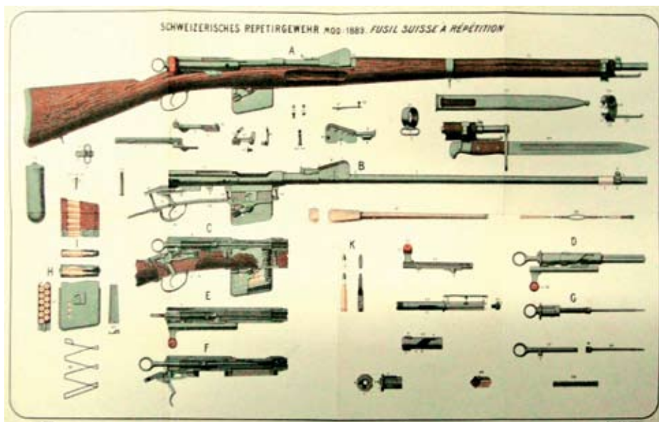
Il “Fucile svizzero a ripetizione” del 1889 scomposto in tutte le sue parti.
