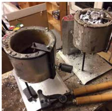
*Forni per la fusione, pinza con blocco a 2 cavità*
