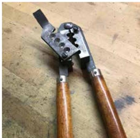
*Blocco pallottiere a 4 cavità montato sulla pinza*
