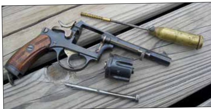
Revolver d'ordinanza 1882 scomposto con kit di pulizia
